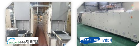
국가혁신클러스터(R&D) 수행 120kW급 고순도 알루미나 건조기 방사성탄소 C-14 재활용 설비
