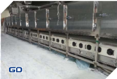
120kW Alumina 건조기 선일플랜트 주식회사 Special Microwave High-technology Engineering
